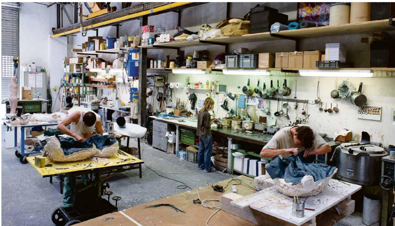
Wachsteile von Urs Fischers «Soft bed» werden retouchiert, bevor sie in keramische Masse eingepackt und zum Trocknungssofen gebracht werden.
