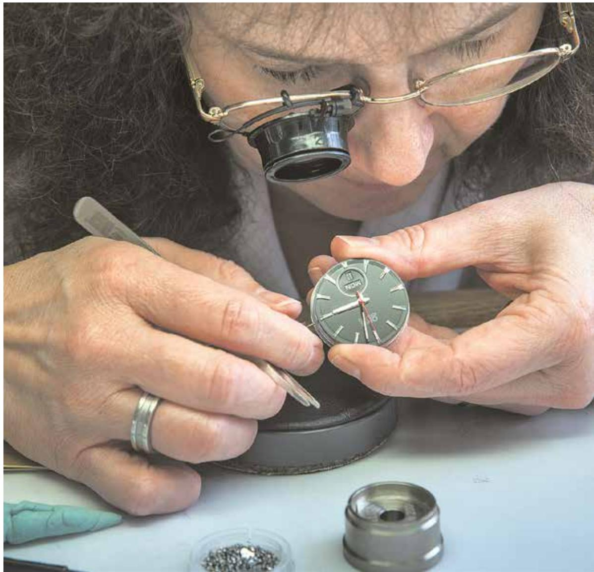
Das Uhrwerk kommt ins Gehäuse: Jedes Staubkorn könnte verheerend sein.
